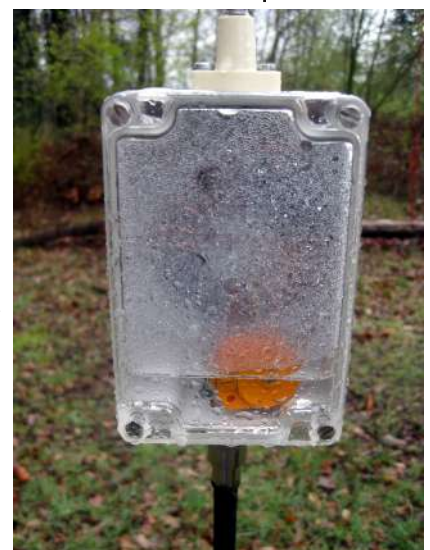
Wel de schroefjes goed aandraaien, anders is de zaak niet waterdicht als het regent...
