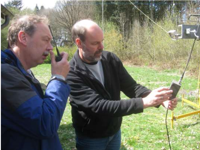
Afregelen van de End-Fed antenne
