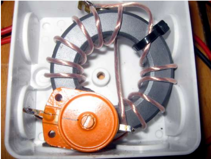
De gewikkelde ringkern, met reeds geplaatste 150pF-C van Dikke Gerrit.
